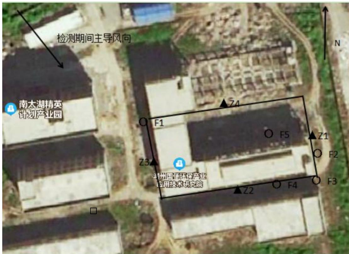
注：○-无组织废气采样点，▲-厂界噪声检测点
