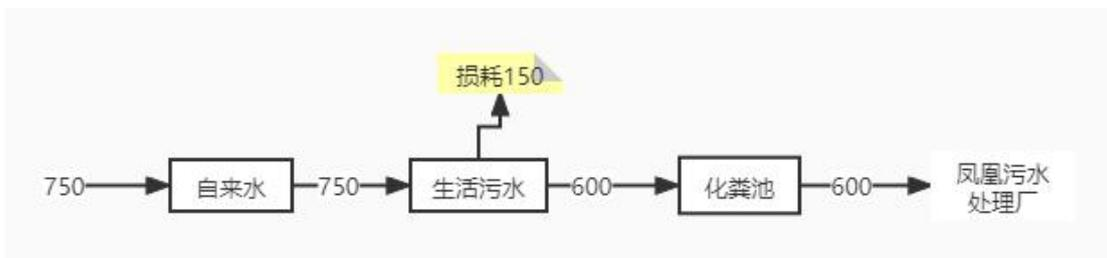
图 3-5 本项目环评审批及实际水平衡图(单位: t/d)
